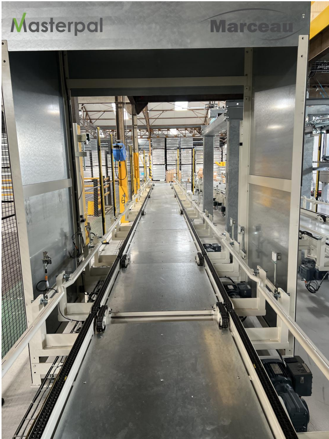
Ligne de convoyage de conteneur avec bracelets de chaînes pour assurer la transition d'un convoyeur à l'autre
