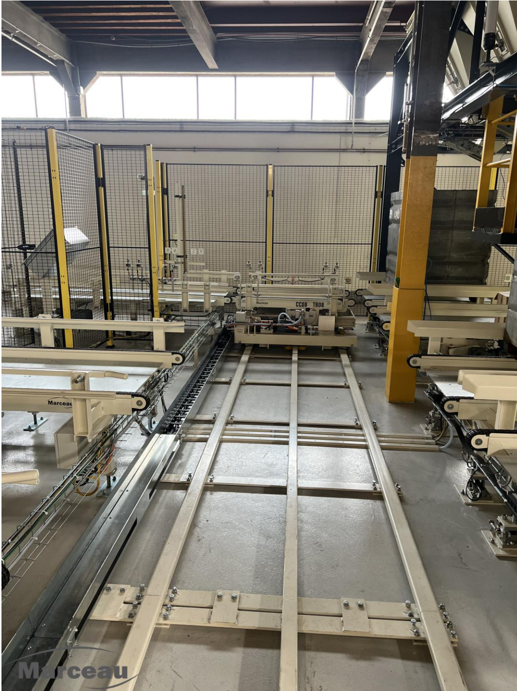
Navette automatique avec système d'accostage pneumatique
